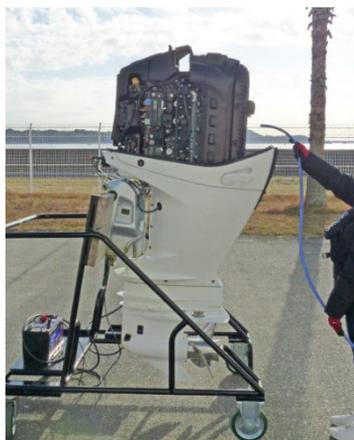
2. きれいな水でエンジンを洗浄し、海水、砂、泥などを洗い流します。
