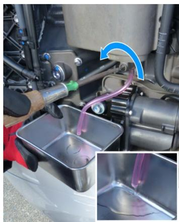
4. ベーパーセパレーターのだレンスクリューをゆるめます。ドレンチューブから燃料が流れ出したら燃料が出終わるまでチルトアップの状態にして待ちます。
